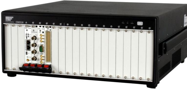
CMX18, 1 sistem denetleyicisi yuvası, 6 PXIe periferik yuvası, 10 PXIe hibrid yuvası ve 1 PXIe zamanlama yuvası ile 18-yuva
